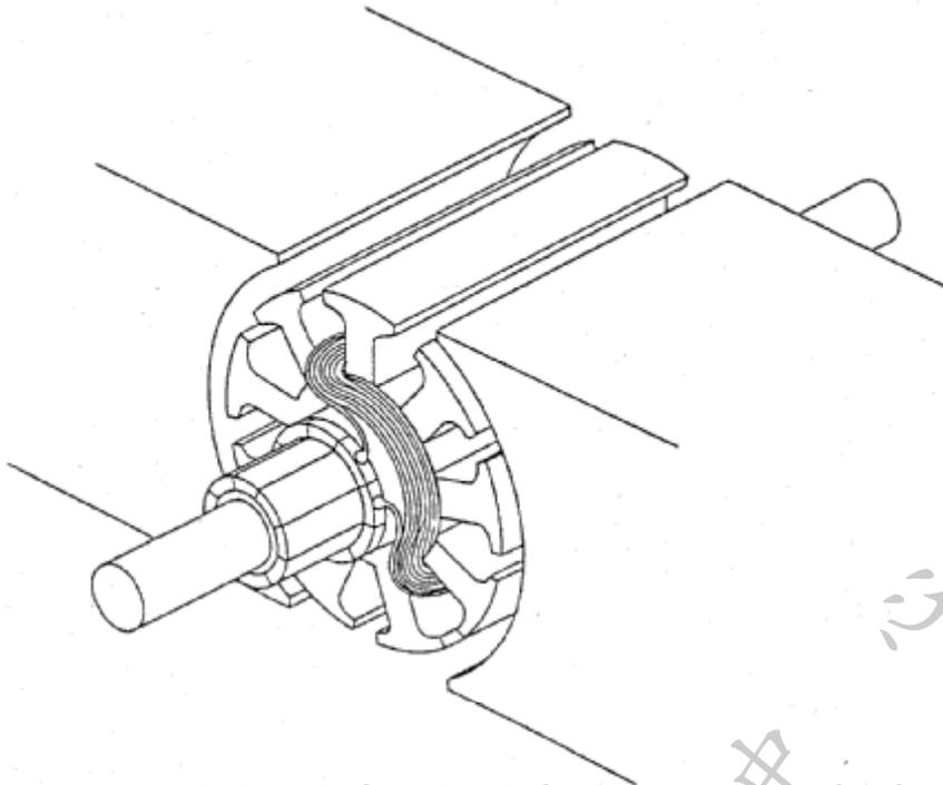
圖1.11 轉向器與線圈的連結(本圖只顯示一條線圈)
