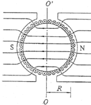
圖1.5 轉子中磁通量和電流的分佈情形
