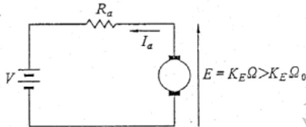
圖 1.14 在正反饋作用下，電流的方向以及反電動勢的大小
