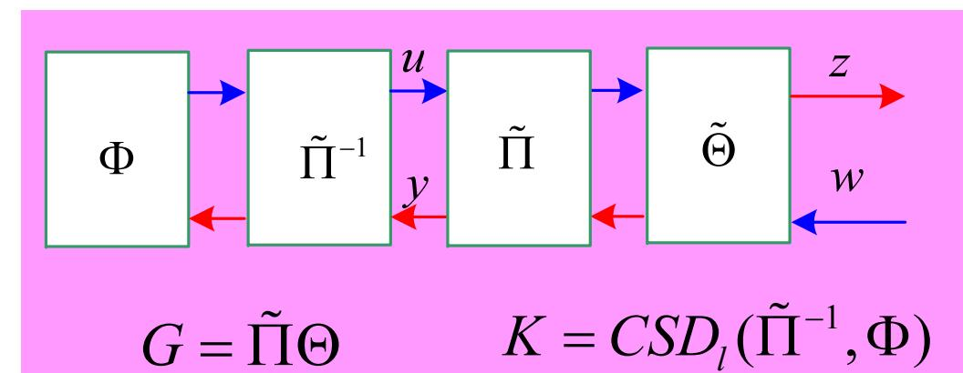
If  $\tilde{\Theta}$  is dual J-lossless  $\|CSD_l(G, K)\|_\infty = \|CSD_l(\tilde{\Theta}, \Phi)\|_\infty < 1 \quad \forall \|\Phi\|_\infty < 1$
