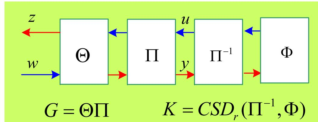
If  $\Theta$  is J-lossless  $\|CSD_r(G, K)\|_\infty = \|CSD_r(\Theta, \Phi)\|_\infty < 1 \quad \forall \|\Phi\|_\infty < 1$
